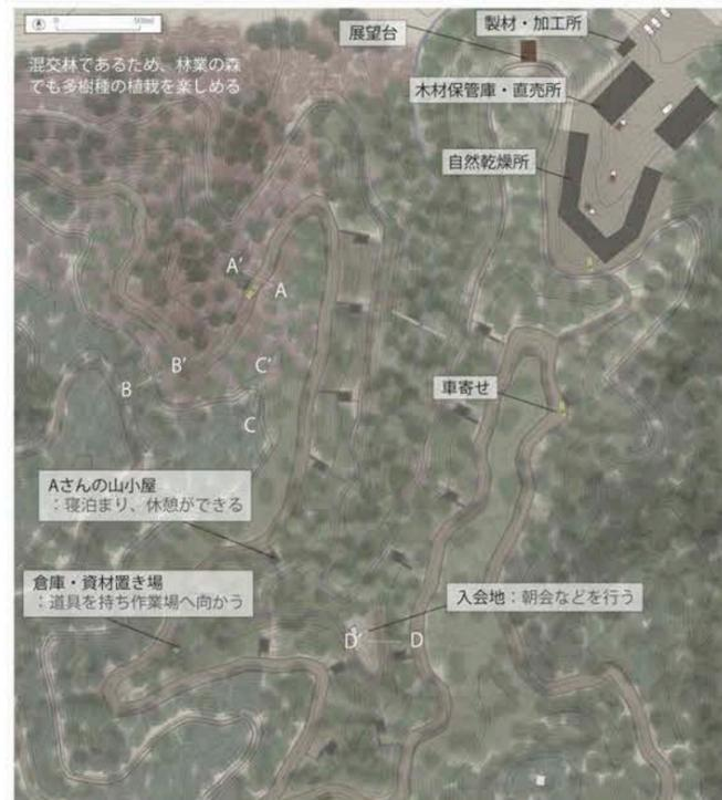
飯能・名栗地方の林道の回らせ方を参考とし、林業初心者が多樹種の森林の隅まで管理を行うことができるような林道計画を行う。林業土木技術である丸太積土留工を用いたデザインとし、毎年の主な管理範囲の変化と共に、林道の位置も変化していく。
